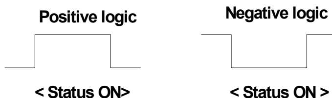
图 7.1 常规输入信号的正逻辑、负逻辑
