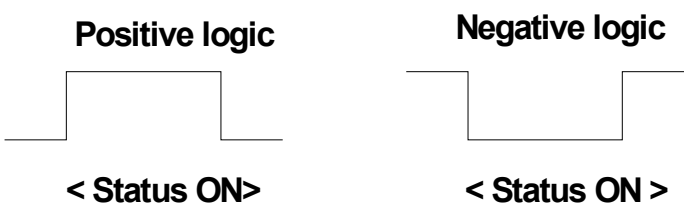
图 7.2 常规输出信号的正逻辑、负逻辑
