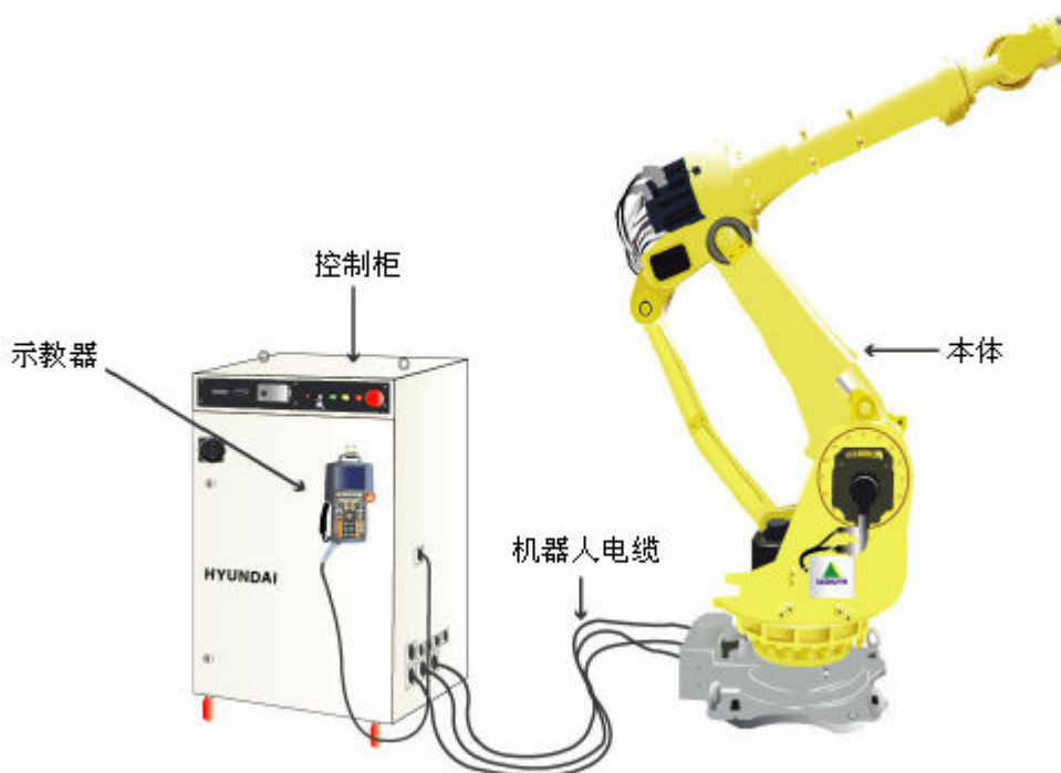
图 2.1 机器人系统的基本结构
