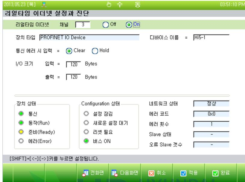
그림 3.2 PROFINET IO-Device 설정 화면
