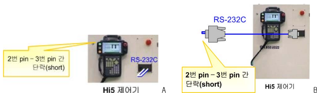
그림 3.12 제어기 캐비닛측 RS-232C 송수신 단락
