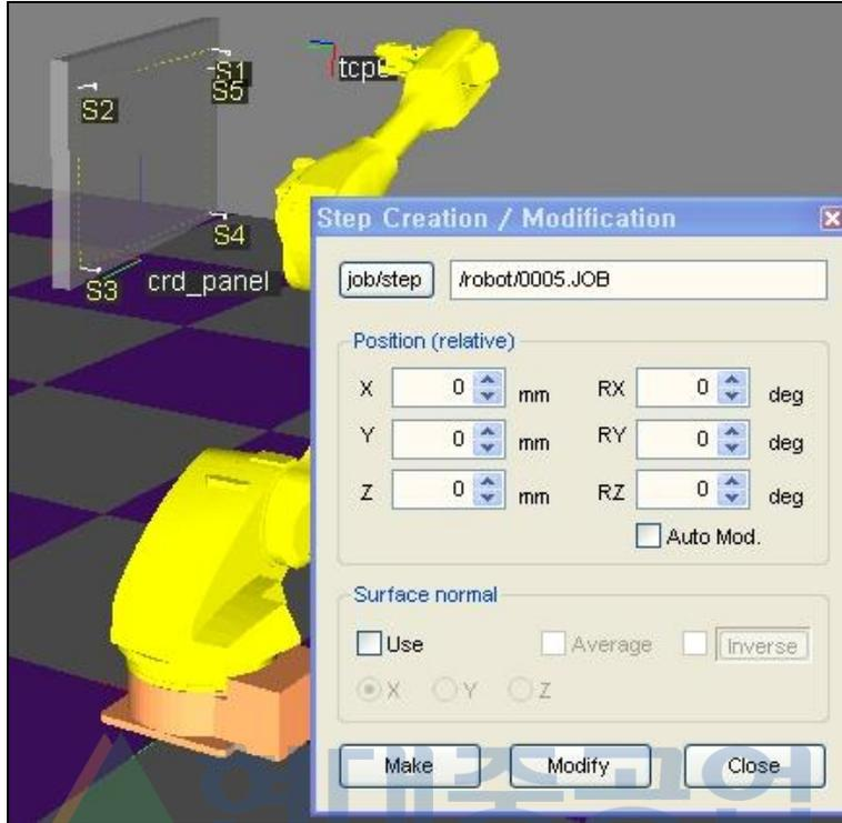
교시가 끝났으면 시뮬레이션을 실행해보십시오. 결과가 정상적이라면, 판넬의 위치/방향을 변경한 후 로봇 속성의 좌표계 페이지에서 'VRC 로 반영' 버튼을 누르고 다시 시뮬레이션 해보십시오. 변경 전과 동일한 판넬 표면 위치들로 틀 끝이 이동함을 알 수 있습니다.
