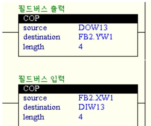
그림 6.2 로봇언어 입출력을 필드버스에 매핑한 내장 PLC 래더의 예
