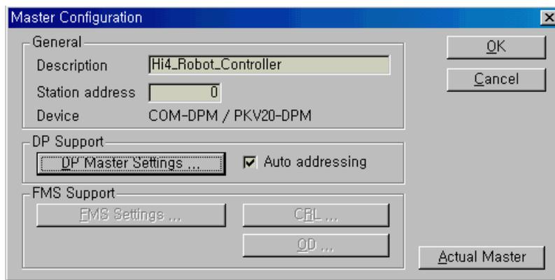
그림 5.8 프로피버스-DP Master Configuration 대화상자
