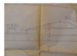
Structure de la couverture temporaire de la cour du casernement (ce système a fonctionné)
