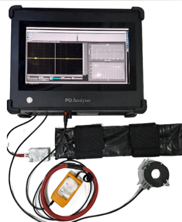
Figura 7 - Fotos reais do sistema construído e seus acessórios (sensores) de medição.
