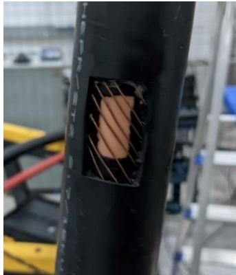
Figura 10 - Avaria do cabo EPR provocada.
