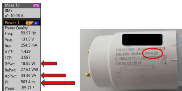
Fig. 4. Resultados de medição em luminária sem filtro de alta frequência, indicando baixo FP com cálculo pelo método P/S e dados de embalagem da luminária (à direita).
