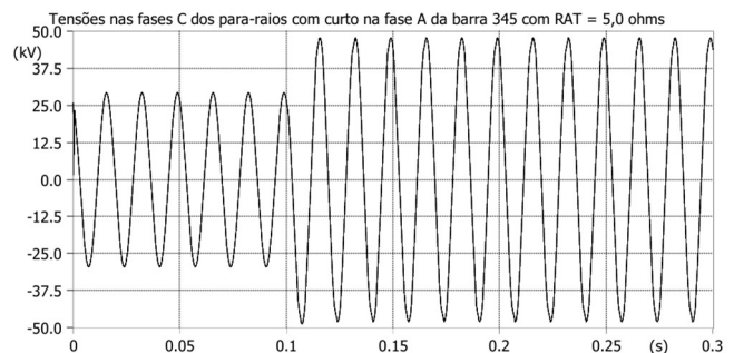
Fig. 8. Tensões nos para-raios para neutro aterrado com RAT = 5 \Omega .
