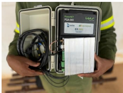
Figura 5 – Foto do Registrador de Qualidade da Energia Elétrica com Oscilografia Contínua.
