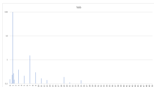
(a) Gráfico de espectro harmônico de tensão Vab medido pelo equipamento do fabricante D.
