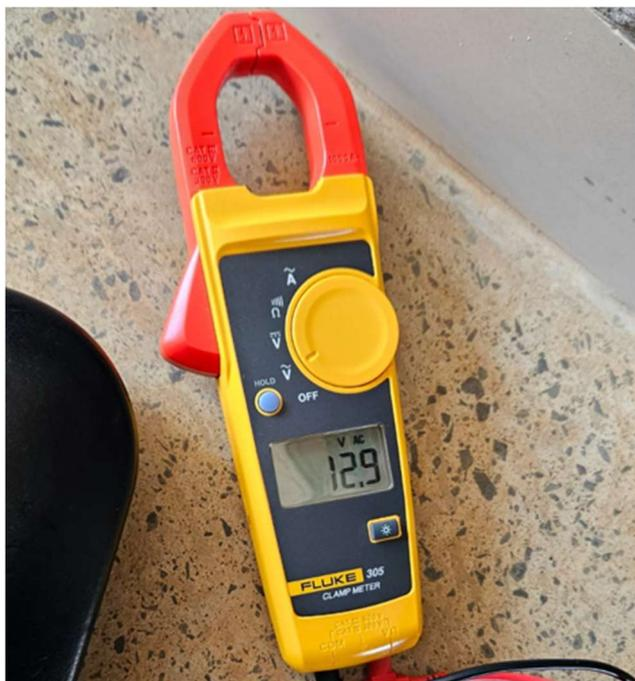
Fig. 4. Medição de tensão entre os barramentos de Fase e Neutro.
