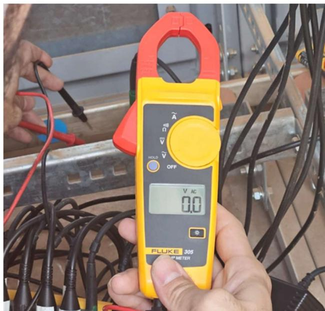
Fig. 6. Medição de tensão entre os barramentos de Fase e Neutro após os ajustes de conexão no aterramento do transformador.
