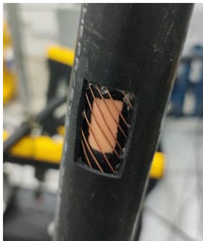
Fig. 3. Defeito induzido para obter descarga de superfície
