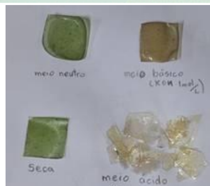
Figura 5 - Membrana com sulfato de cobre.
