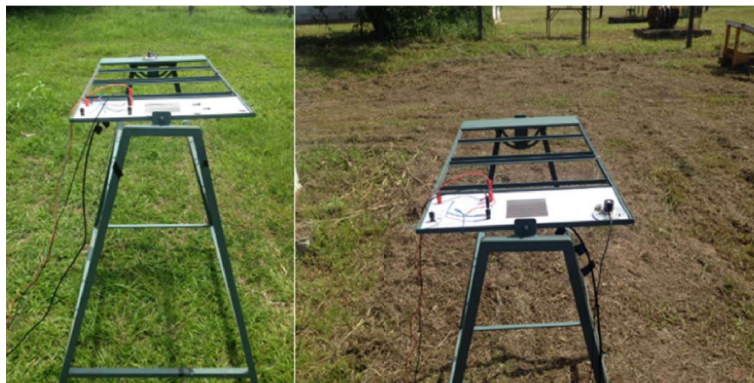
Figura 2 - Estrutura utilizada para ensaios outdoor.
