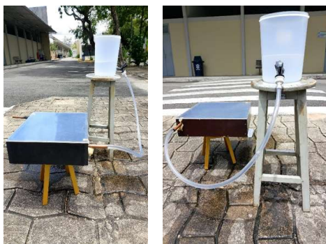
Figura 2 – Visão frontal e lateral do protótipo do sistema térmico solar modelado
