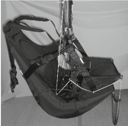
An den meisten handelsüblichen Gurtzeugen sind Rollen für das Beschleunigungssystem angebracht. Die Beschleunigerleinen werden von vorne durch die Rollen am Gurtzeug nach oben geführt und in der richtigen Länge mit den Brummel-Haken verbunden.
