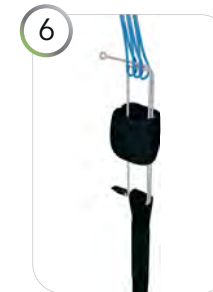
Schiebe das Ende der Schlaufe zunächst nach oben durch die elastische Hülse (nicht mehr durch das Röhrenchen) und dann nach demselben Muster durch die Leinen.
