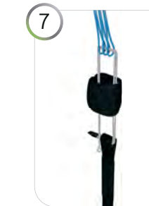
Schiebe das Schlaufenende zuerst nach unten durch die Hülse (nicht durch das Röhrenchen) und dann erneut durch die Schlaufe mit dem verstärkten Ende (schwarze Lasche).
