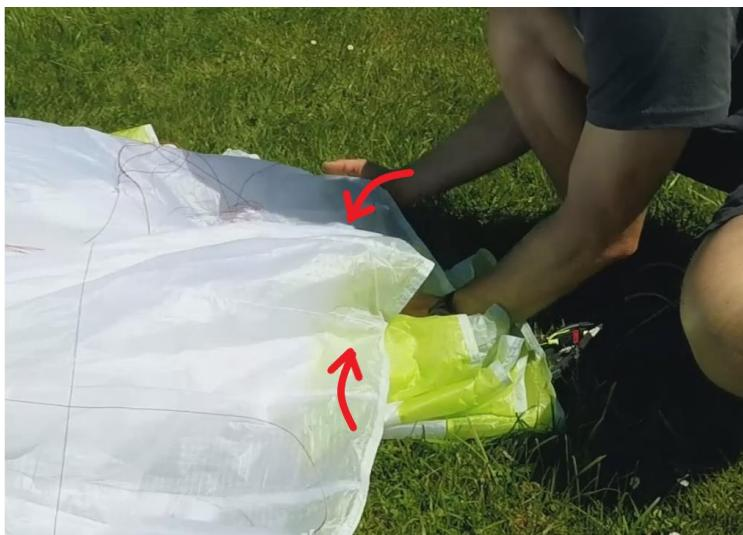
6. Utilisation de l'AirPack 50/50 : Rabattez l'aile du bord de fuite une fois sur la longueur du sac intérieur (le AirPack 50/50 mesure la moitié de la corde de l'aile).
