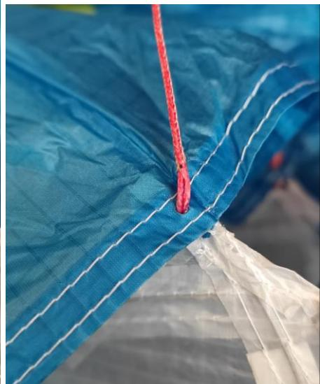
Leinen A11-12 werden auf eine Standard-Leinenschlaufe eingehängt, welche sich zwischen originaler A und Eintrittsöffnung befindet.
