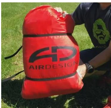
En utilisant le "AirPack" standard, le parapente entier sera d'abord mis dans le sac intérieur, puis fermé, puis plié à la longueur requise et fixé avec les sangles.
