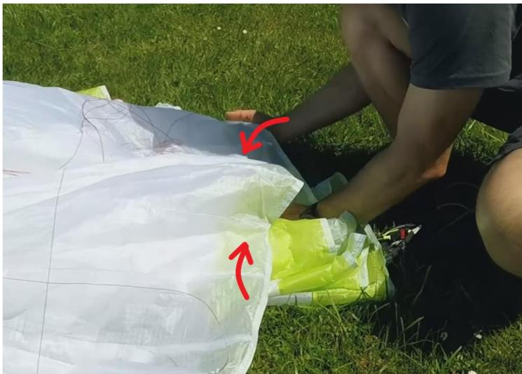
6. Beim **50/50 AirPack** wird nun lediglich der Schirm am Ende des Innenpacksackes einmal gefaltet und in den Innenpacksack gelegt. Der AirPack wird geschlossen und danach nochmals halbiert und mit den außenliegenden Kompressionsbändern fixiert.
