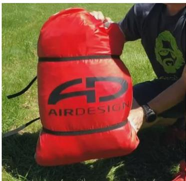
7. Bei Verwendung des **Standard „AirPack“** wird der Schirm in der gesamten Flügeltiefe in den Innenpacksack gelegt, dann geschlossen und danach auf die gewünschte Länge gefaltet.
