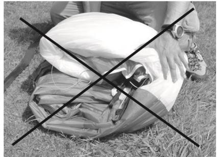
6. Der Schirm wird nun von der Hinterkante aus 2 bis 3 mal zusammengelegt und dabei die Luft herausgestreift. Es ist wichtig noch einmal zu kontrollieren, dass die bereits gepackten Zellwände der Eintrittskante flach aufeinander liegen. Die Eintrittskante darf NICHT in den Schirm hinein gefaltet werden, denn das könnte die Nylonstäbchen verbiegen oder beschädigen.
