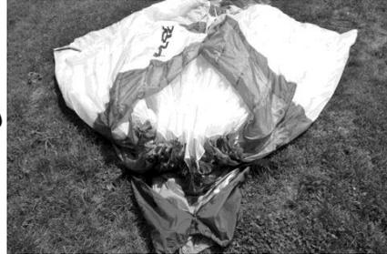
3. Nun wird die geraffte Eintrittskante seitwärts auf den Innenpacksack bzw. AirPack gelegt und das Innengurtband direkt hinter den Nylonstäbchen geschlossen.
