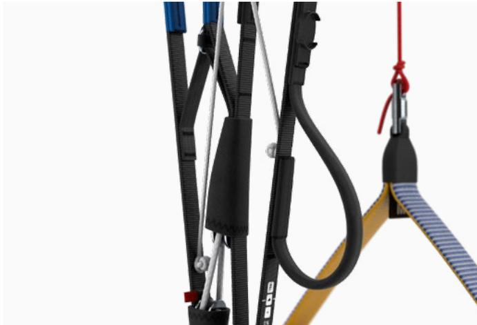
Greife beim beschleunigten Fliegen die C-Handles mit dem Zeige- oder zusammen mit dem Zeige- und Mittelfinger. Achte darauf, dass die Bremsen dabei nicht gewickelt sind. Durch dosiertes Ziehen und Freigeben steuerst du bei leichten Turbulenzen etwaigen Pitchbewegungen entgegen. Ausserdem gleichst du damit niedrigeren Kappeninndendruck, wie er z. B. bei Klappern entsteht, aus.
