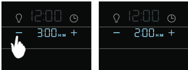
Figure 25 : Régler le nettoyage de 2 h
