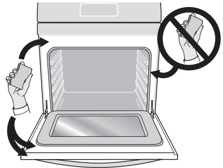
Figure 23 : Nettoyer la partie autour du joint de la porte du four
