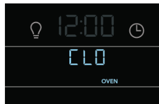
Figure 28 : Message invitant l'utilisateur à fermer la porte du four pour que le cycle de nettoyage puisse démarrer
