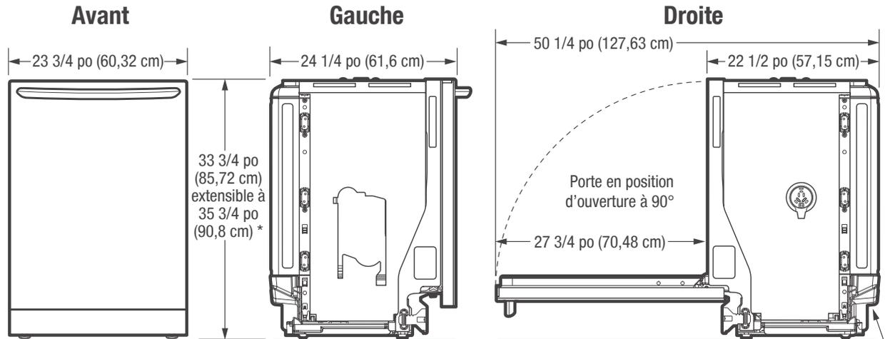
\* La hauteur ne peut être étendue jusqu'à 35 3/4 po max. que dans une installation en découpe d'armoire standard de 35 3/4 po max. (Les dimensions ne comprennent PAS l'isolation – la couverture isolante peut être comprimée à l'installation.)
