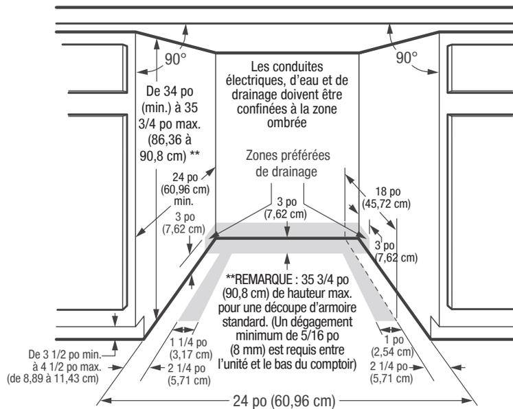
**Remarque :** Aux fins de planification seulement. Consultez systématiquement les codes locaux et nationaux d'électricité, de gaz et de plomberie. Reportez-vous au guide d'installation du produit pour des instructions d'installation détaillées sur le web à [frigidaire.com/frigidaire.ca](http://frigidaire.com/frigidaire.ca).
