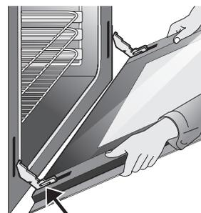
**Figure 23: Retirez soigneusement la porte en tenant les deux côtés et en tirant les charnières hors du cadre de la porte.**
