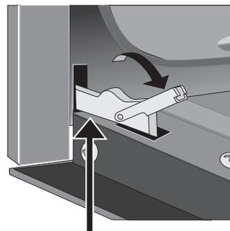
**Figure 22: Déverrouillez les charnières pour retirer la porte**
