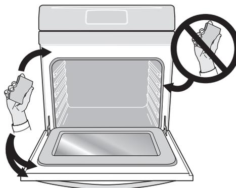
**Figure 16: Zones à nettoyer et à ne pas nettoyer (joint)**
