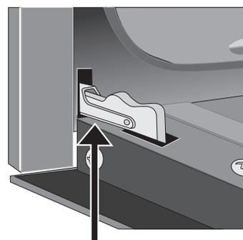
**Figure 21: Charnière en position verrouillée**
