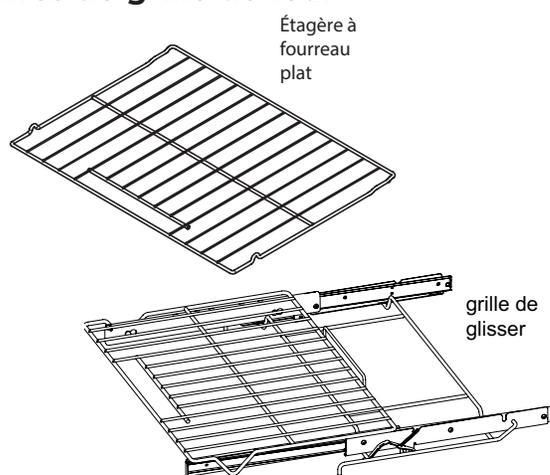
Figure 2: Types de grilles de four
