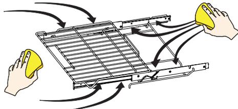
3. Agitez la lubrification au graphite avant l'application. Appliquez sur les guides de chargement et l'axe de rotation. Répétez sur les deux côtés de la grille à glissière.
