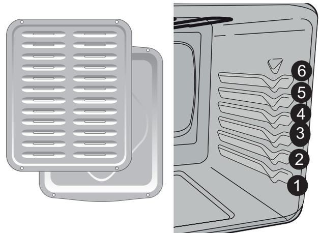
Figure 10: Lèchefrite avec grille (G) et positions de la grille (D)
