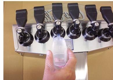
Reinigen Sie die Hähne mit der Reinigungs-Sprühflasche und der Bürste und spülen Sie mit dem Reinigungsball gefüllt mit sauberem Wasser nach. Spülwasser nicht in den Reinigungsball zurücksaugen.
