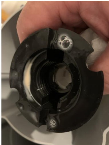
Abbildung 14: Kontaminiertes Wasserventil im Vorspülbecken. Der Biofilm kann nur dann erfolgreich entfernt werden, wenn das Gerät komplett zerlegt wird.
