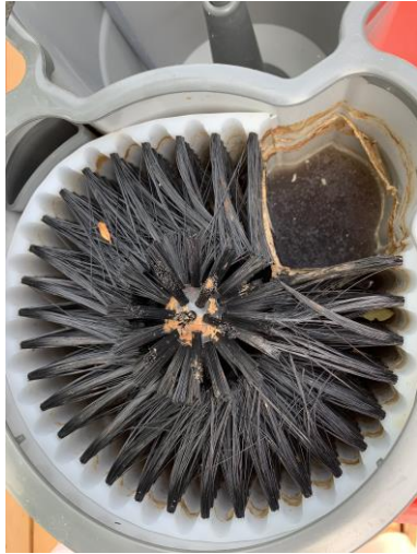
Abbildung 7: Verschmutztes Vorspülbecken nach 4 Wochen mit deutlich sichtbaren Belägen und einer trüb-braunen Flüssigkeit im Inneren
