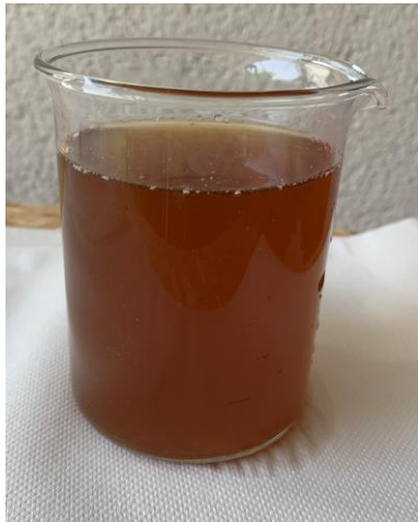
Abbildung 8: Verschmutzungsmatrix des Vorspülbeckens, mit welcher auch die Gläser für die Reinigkeitstests kontaminiert wurden. Der Keimgehalt betrug >2,5 \times 10^7 KBE/ml
