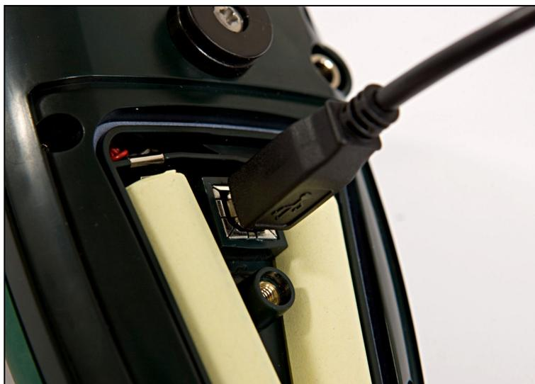
Ist das **aspida** an einen PC angeschlossen, schaltet es sich automatisch ein, falls es noch nicht eingeschaltet wurde. Anstelle des Batteriesymbols erscheint im **aspida** Display das USB-Symbol (siehe unten).
