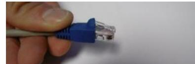
**Muffe über Verriegelungsvorrichtung zurückschieben**
