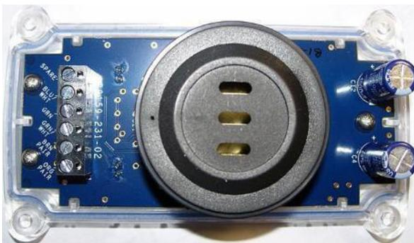
**HINWEIS: ALLE ALARME EINES GEMEINSAMEN SENSORS SOLLTEN IN REIHE GESCHALTET UND SO MITEINANDER VERBUNDEN WERDEN. WENN BEISPIELSGEWEISE SENSOR 1 ZWEI ALARME TREIBEN MUSS, SOLLTE EIN KABEL ZWISCHEN SENSOR 1 UND ALARM 1 VERLAUFEN UND EIN KABEL ZWISCHEN ALARM 1 UND ALARM 2 (BEACHTEN SIE DAS BEISPIEL IN ABSCHNITT 7.4.2).**
