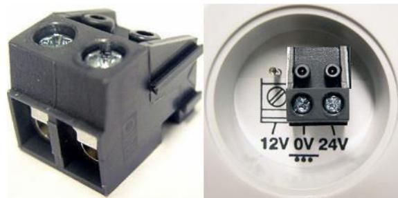
(links) Die Reihenklemme der Leuchte. Stellen Sie sicher, dass diese mit den 0 V und 24 V Klemmen verbunden ist (rechts).
