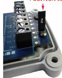
MODBUS-Anschlüsse an ein Gebäudemanagementsystem können über eine RS485-Verbindung mit COM A & B erfolgen. Siehe Ax60+ Servicehandbuch P0159-803.
