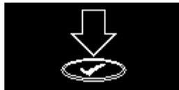
**Abbildung 6 – Displayanzeige bei Auslösung eines Person-liegend-Alarms**
