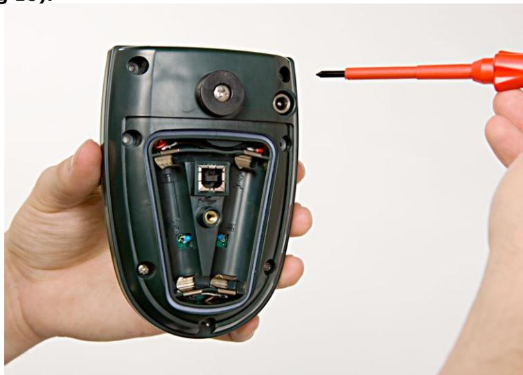
**Abbildung 16- Entfernen der Sensorkappenschrauben**
