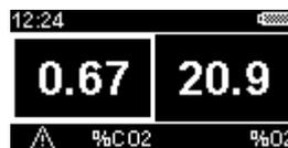
**Abbildung 5 – Das Hauptgasdisplay zeigt an, dass die Kohlendioxidkonzentration einen Alarm ausgelöst hat**
