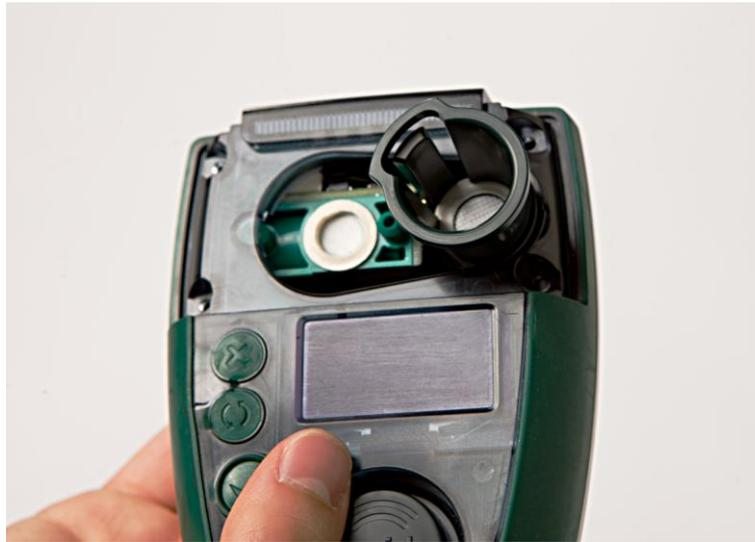
**Abbildung 20 – Korrekter Sitz des Abziehwerkzeugs**
