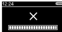
**Abbildung 14 – Sauerstoff-Frischlufthkalibrierung fehlgeschlagen**
