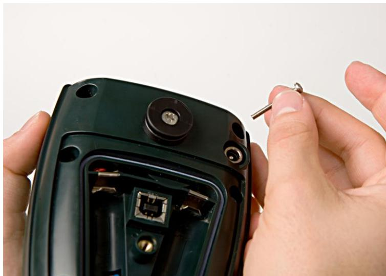
**Abbildung 27 – Wiederanbringen von Sensorkappe und Schrauben**
