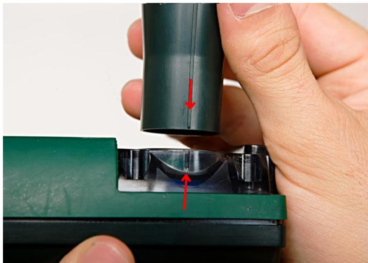
**Abbildung 19 – Richtige Positionierung des Abziehwerkzeugs**
