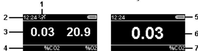
**Abbildung 3 – Display Zweifachsensor (links), Display Einzelsensor (rechts)**
