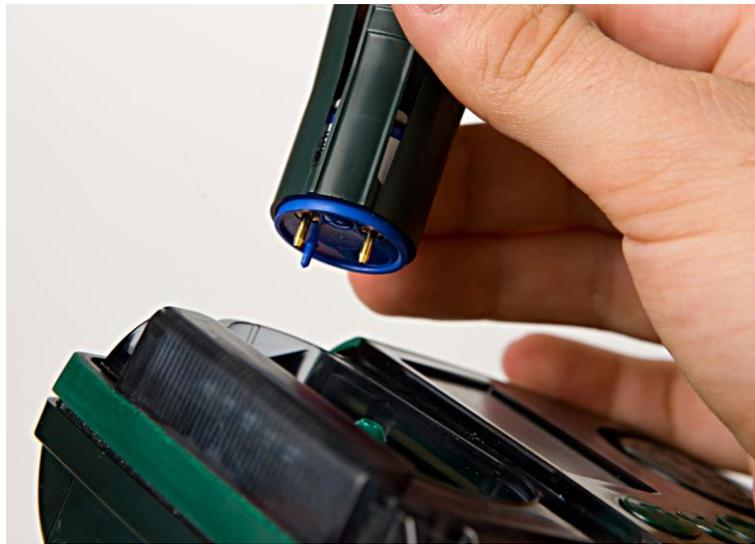
**Abbildung 22 – Herausziehen des Sauerstoffsensors**
