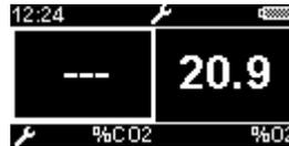
**Abbildung 11 – Display zeigt einen Fehler des Kohlendioxidsensors an**
