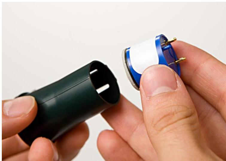
**Abbildung 23 – Einstecken des neuen Sensors in das Abziehwerkzeug**
