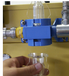
6. Adapterschauglas wieder am Ventil befestigen
