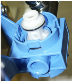
4. O-Ring mit Hahnfett einfetten, Kolben mit nebeneinanderliegenden Bohrungen zur Wasserzulaufseite einsetzen
