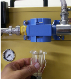
1. Adapterschauglas vom Ventil lösen
