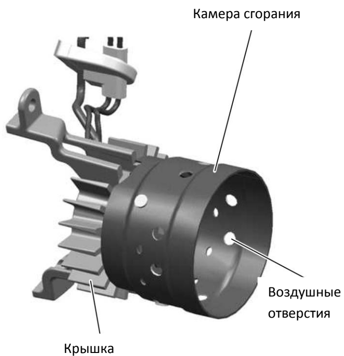
Рис. 5-5 Визуальный контроль, горелка в сборе
