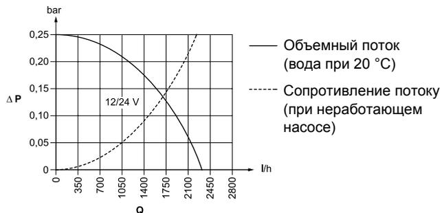
рис. 6: Объемный поток и сопротивление потоку
