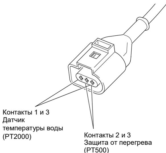
Рис. 502 Штекер датчиков температуры
