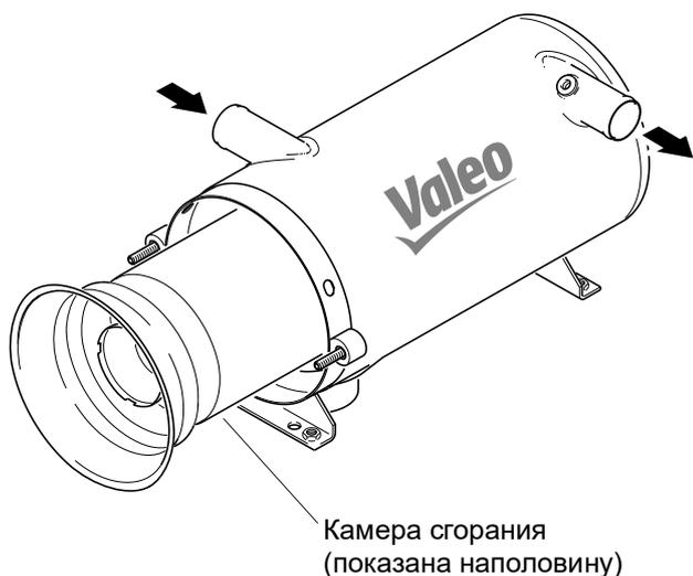
Рис. 310 Камера сгорания
