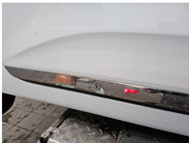
Bild 2: Außen, Tür hinten rechts - Schutzleiste unten, beschädigt, erneuern
