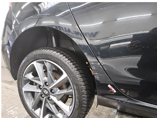
Bild 3: Außen, Seitenteil hinten rechts, Verformung , instandsetzen und lackieren mit Lackaufbau
