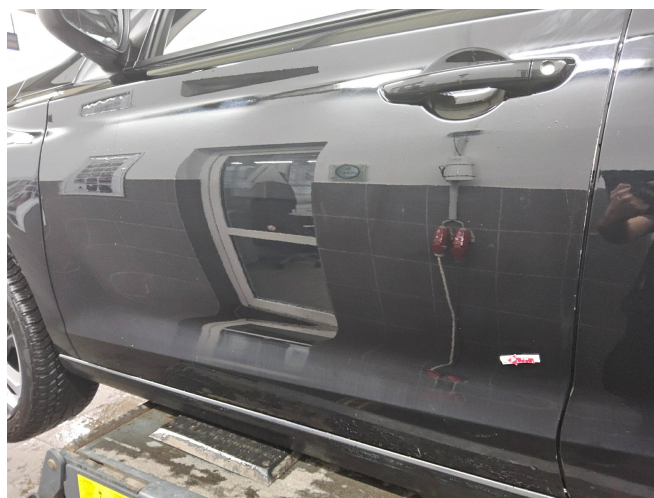
Bild 6: Außen, Tür vorne links, Dellen, Kratzer , smart repair
