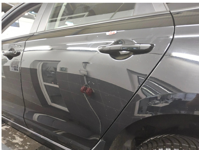
Bild 1: Außen, Tür hinten links, Dellen, Kratzer , smart repair
