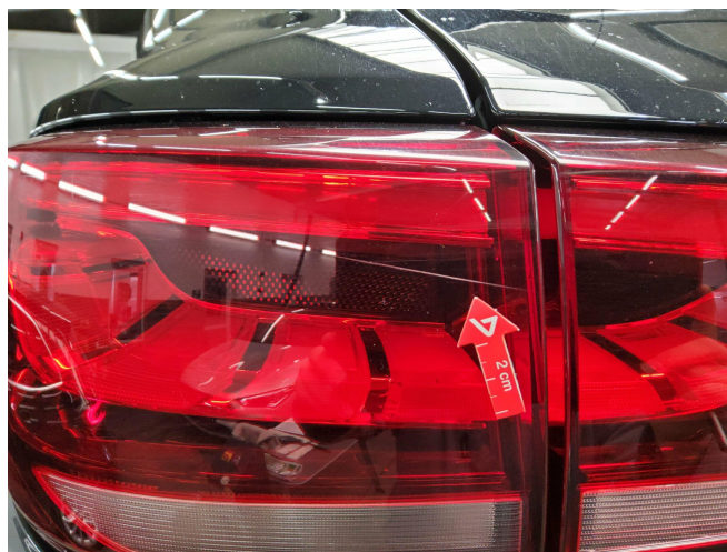
Bild 4: Außen, Rückleuchte links, Kratzer , keine Maßnahme
