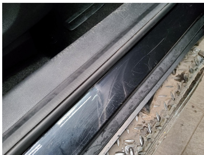
Bild 2: Außen, Türeinstiege , Kratzer , smart repair
