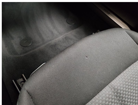
Schaden 6: Innenraum - Brandloch
