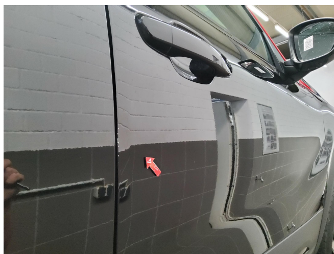
Bild 6: Außen, Tür vorne rechts, Verformung, Kratzer , instandsetzen und lackieren mit Lackaufbau
