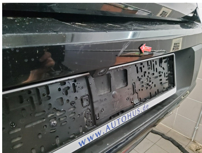
Bild 4: Außen, Stoßfänger hinten, Kratzer , lackieren
