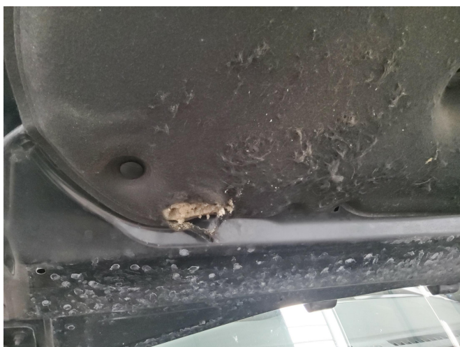
Bild 1: Innen, Dämmmatte Motorhaube, beschädigt , erneuern
