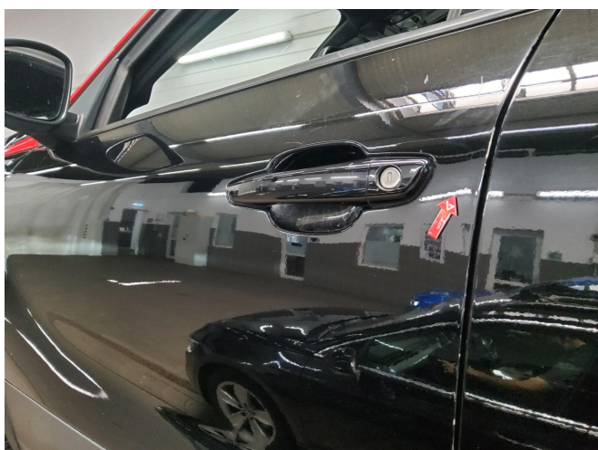
Bild 5: Außen, Tür vorne links, Kratzer , smart repair
