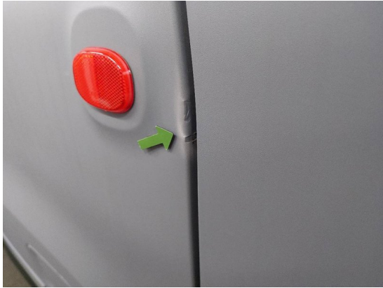
Schaden 1: Tür vorn links - Delle
