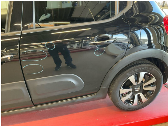
Schaden 1: Tür hinten links - Delle und Kratzer
