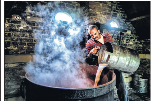
de ketel in (links onder) waar het kapot gekookt wordt. De gekookte massa gaat vervolgens in de pers (rechtsboven en losse foto rechts) om sap en pulp te scheiden. Het sap gaat daarna (rechtsboven en losse foto rechts) om sap en pulp te scheiden. Het sap gaat daarna
