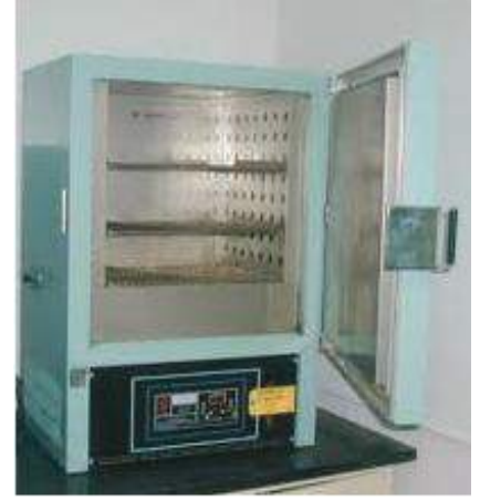
فرن التجفيف يستعمل لتجفيف الراسب عند درجات حرارة عالية قد تصل 100^\circ\text{C}
