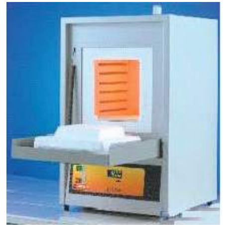
فرن الحرق يستعمل لحرق الراسب عند درجات حرارة عالية قد تتجاوز 1000^\circ\text{C}
