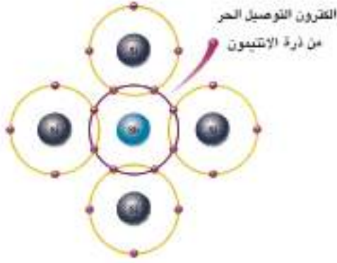
شكل (13) بلورة شبه موصل نوع (N)
