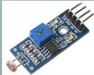
Sensor de luminosidad por fotoresistor
