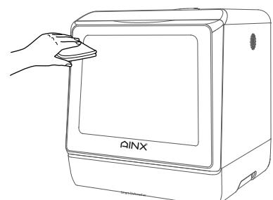
▶ノズルの噴射水が直接当たらない庫内及び扉下部付近は、下部洗浄トレーを取り出してからよく絞った柔らかい布で拭いてください。
