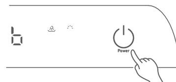
電源アダプターをコンセントに差し込み、電源ランプが点滅しているスタンバイ状態で洗淨・すすぎに必要な水量（約5ℓ）を給水してください。
