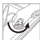
フィルターを反時計回りに回して上に引き上げます。
